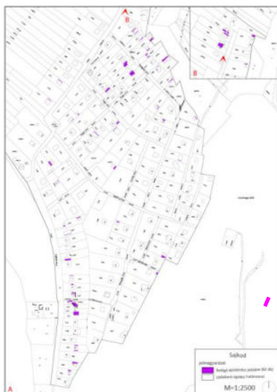
Építési helyből kilógó épületrészek, Sajkod
